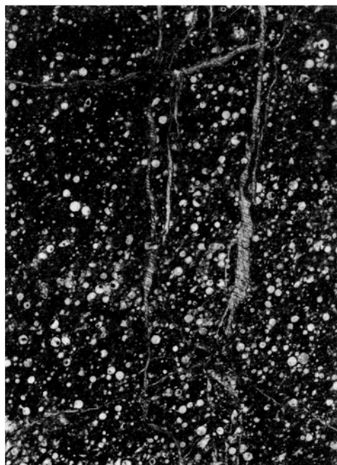
Hornstein der Danau-Formation von Britisch-Nord-Borneo, erfüllt von Radiolarienresten, mit einigen Kalkitaderchen. Vergrößerung 16 fach.
